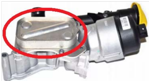
Radiatore di raffreddamento olio equipaggiato da scambiatore di calore
